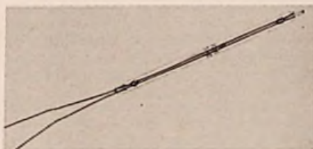
Bild 2. Der Thernewid-Heißeleiter-Temperaturfühler K 16 dient zur fast trägheitslosen Temperaturmessung bis zu 200° C. Er kann auch als Temperatur-Sonde im lebenden Körper verwendet werden (Siemens)
