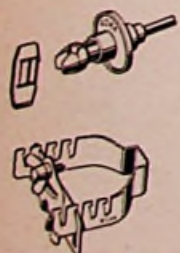
Bild 6. Der neue Roka-Bola-Isolator für Flach- oder Rundkabel. a) Einsatz für Bandkabel aus der Klemmzange entfernt, b) neue Schnellspannungsschelle für den Bola-Isolator
