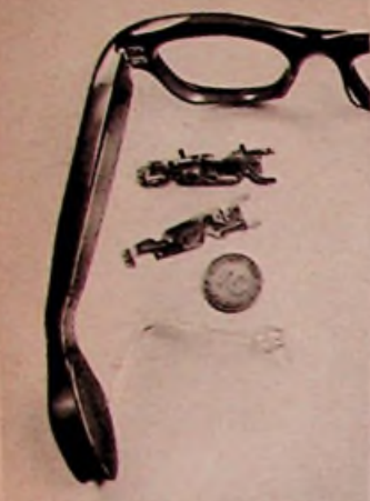
Bild 4. Teilbild der Siemens-Reiniger-Rodenstock-Hörbrille für stereophonisches Hören. Daneben die geätzte Schaltung und ein fertiger 3stufiger Transistorverstärker
