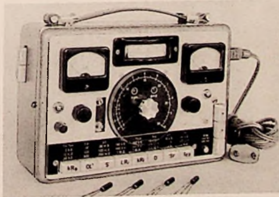
Das Transistor-Meßgerät Teletrans I von Telefunken. Es dient zur exakten Arbeitspunktinstellung und zum Ausmessen von insges. 13 statischen und dynamischen Transistor-Kenngrößen
