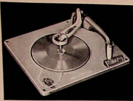
Bild 4. Das neue Plattenwechsler-Chassis 1007 von Philips arbeitet automatisch mit Drucktasten und Stroboskop-Kontrolle der Umdrehungsgeschwindigkeiten. Als Tonabnehmersystem wird ein magnetodynamisches System hoher Qualität verwendet
